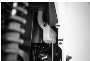
Θέση δοχείου ψυκτικού υγρού
