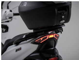
Έλεγχος φώτων πέδησης (στοπ)
