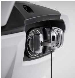
Ενεργοποίηση με κλειδί του κεντρικού διακόπτη
