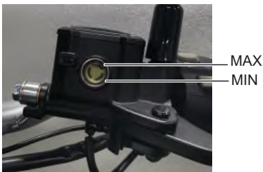
Παράθυρο ελέγχου υγρού φρένων
