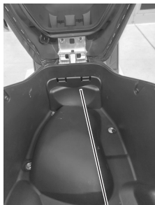
Καπάκι επιθεώρησης μπαταρίας κλειστό
