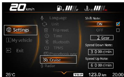
Ρύθμιση ένδειξης στροφόμετρου για αλλαγή ταχύτητας
